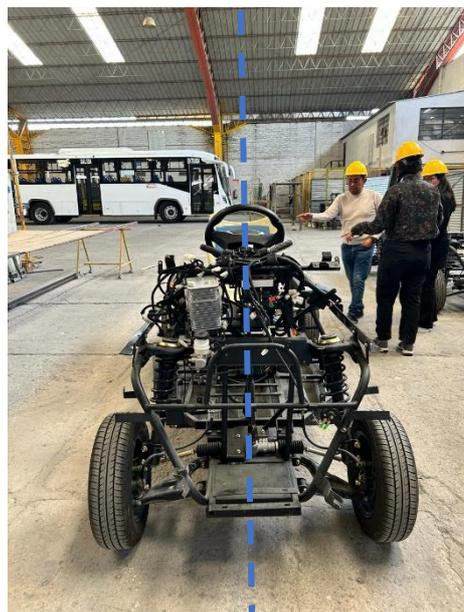
**Gráfico 1, izquierda** (Chasis y Sistema de Dirección importado modificado) y **Gráfico 2, derecha** (Chasis y Sistema de Dirección importados sin modificar)
